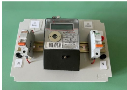
Фиг.16 Снимка на лабораторното устройство с монтиран статичен електромер и схема на свързване към автоматични прекъсвачи.
