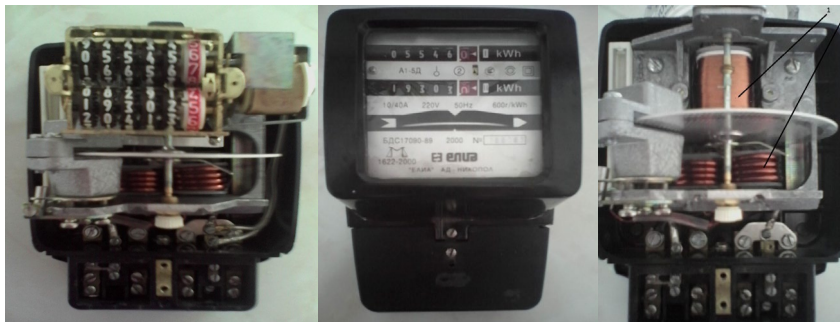
Фиг.1. Реален изглед на еднофазен индукционен електромер марка „Елиа” Тип А1-5Д. 1 – напреженова намотка 2 – токова намотка
