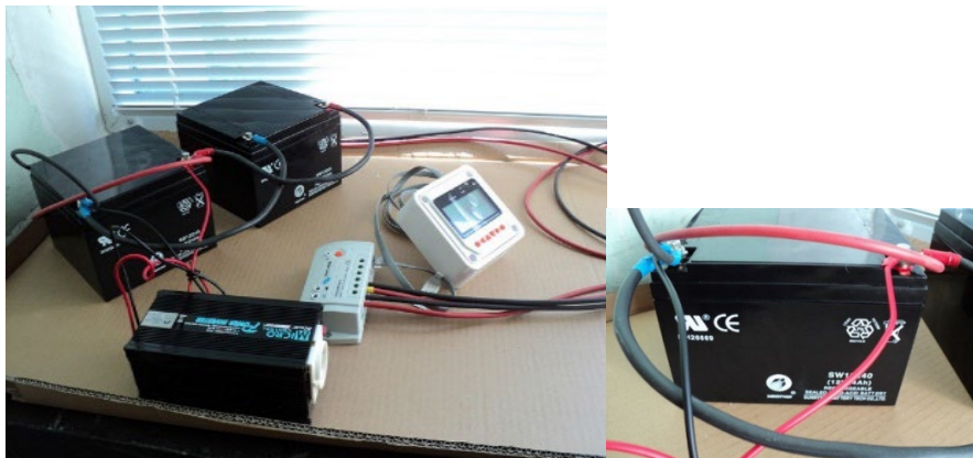
Фиг.3. Снимка на свързани в схема елементи от соларната система.
