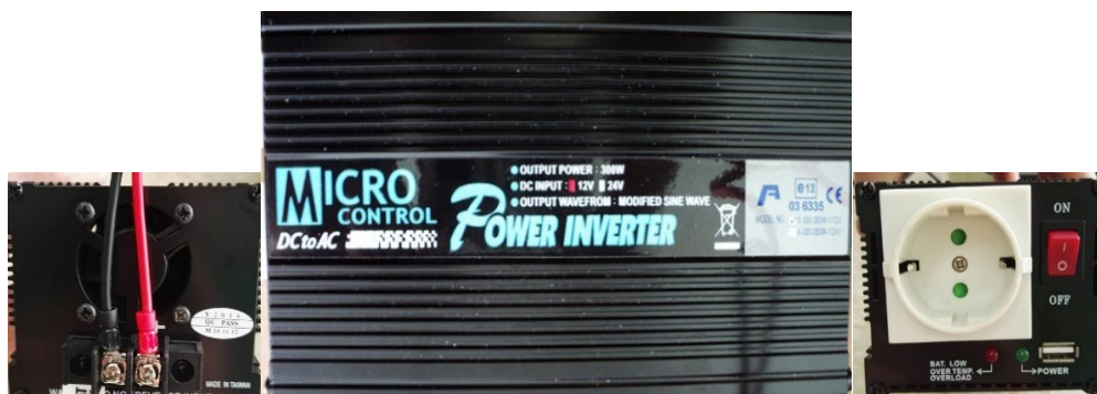
Фиг.4. Снимка на кутията и входен излаз вляво и изходен излаз вдясно на инвертора на напрежение с модифицирана синусоида
