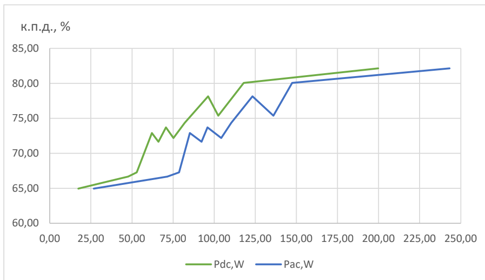
Фиг.10. Графично представяне на зависимост между ефективността на инвертора от изменението мощностите на консуматора в относителни единици
