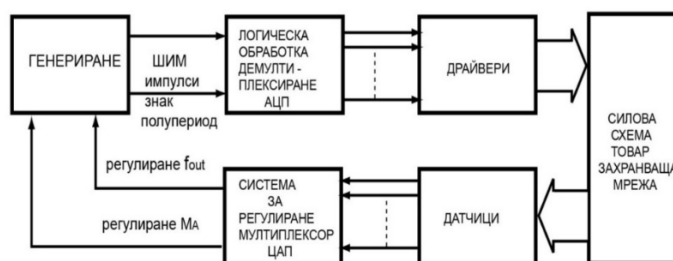
Фиг.1. Обща структурна схема на система за управление на силова част от инвертор.
